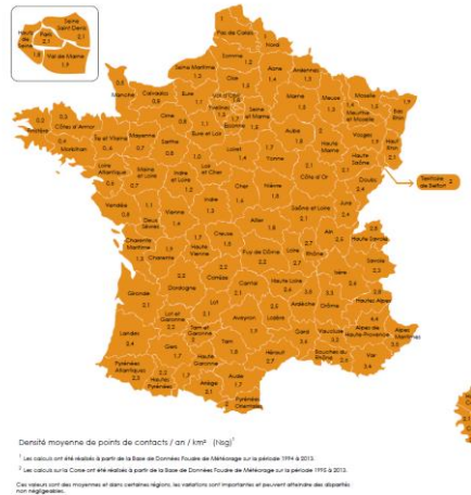
Figure 20 : Carte de la densité de foudroiement de la France issue de la norme NFC 17-102 (05-2015)
